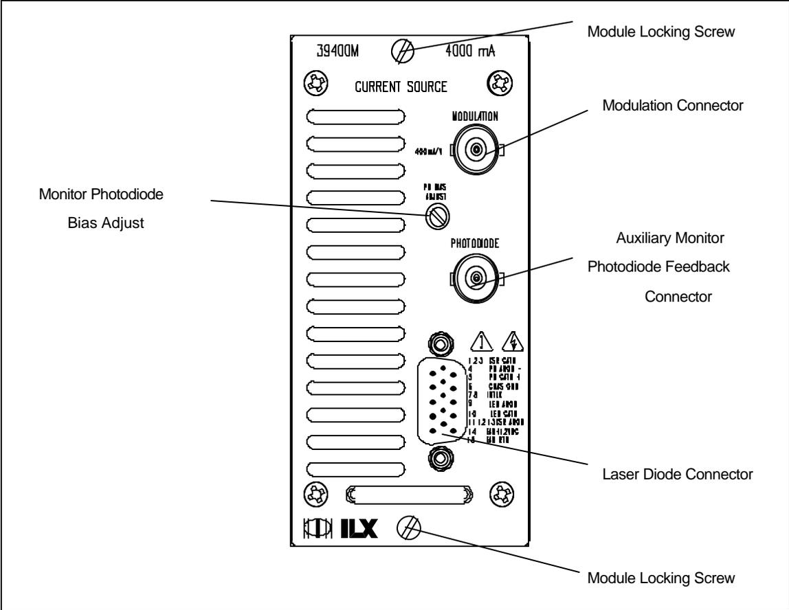
**Figure 4.1 CSM-39400M Back Panel**
